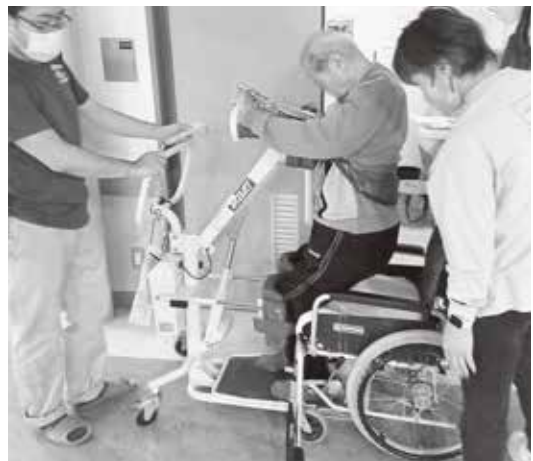
車いす利用者を介助する電動福祉用具 利用者の腰と足に巻きつけて、起立や着席を補助する (写真提供：社会福祉法人みまき福祉会)
