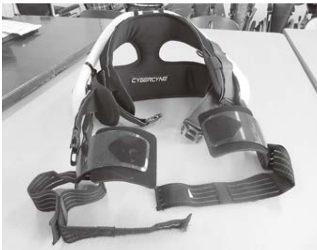
職員の負担を軽減するために導入された介護ロボット (HAL)
