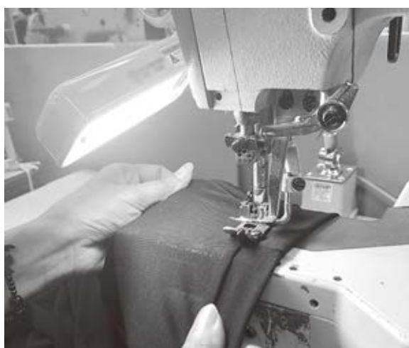
高齢者の視力低下を補うために導入したLED照明（ミシンの左側）
