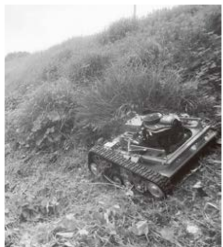
高齢従業員の作業負担軽減のため導入しているリモコン式大型草刈機
