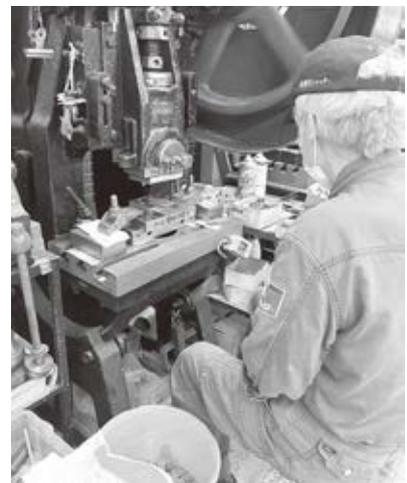
高齢社員が座りながら作業できるように、着席時の視点に合わせて機械を設置している
