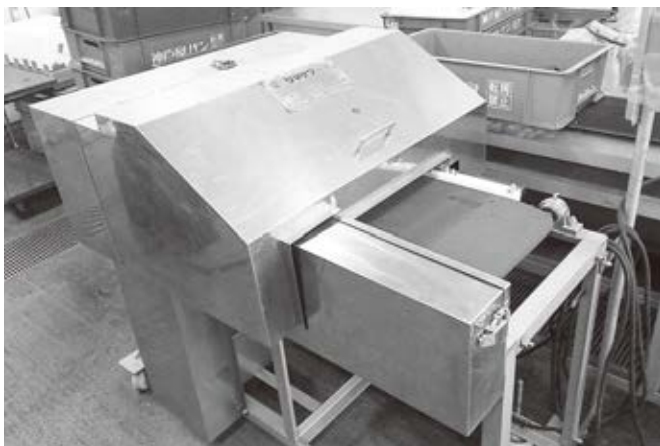
高齢従業員の作業負担を軽減した魚の皮剥器
