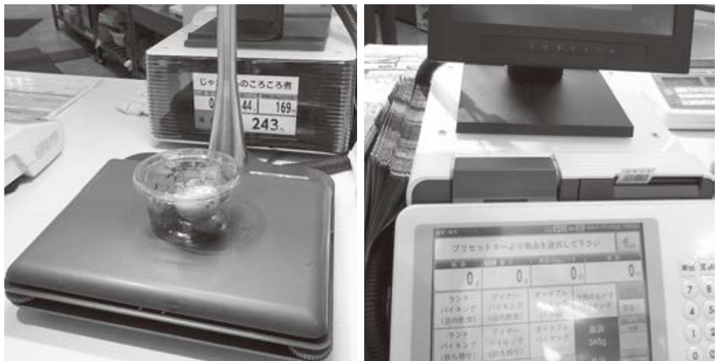
AIを活用した総菜自動会計システム。自動的に商品を識別し、モニターをタッチすることでレジに精算額が反映される
