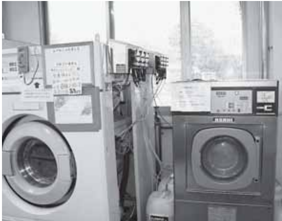
洗剤、柔軟剤、消毒液が自動で投入できる最新の洗濯設備
